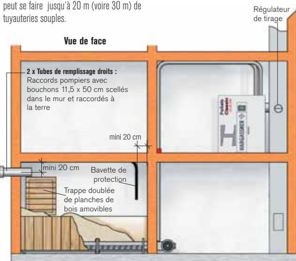
Le silo peut se trouver à un niveau inférieur à celui de la chaufferie, cela ne pose aucun problème pour le système de transfert pneumatique Hargassner.
