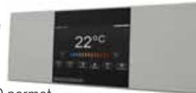
Pour chacune des zones et depuis votre habitation, le report de commande digital FR40 permet de forcer le mode confort, le mode réduit, le mode arrêt ou le mode soirée et de modifier la consigne de température de la zone. De plus, il peut être paramétré avec ou sans correction de la température d'ambiance selon la configuration de la zone concernée. Il est équipé d'un voyant rouge qui vous informe d'un éventuel défaut sur la chaudière.
