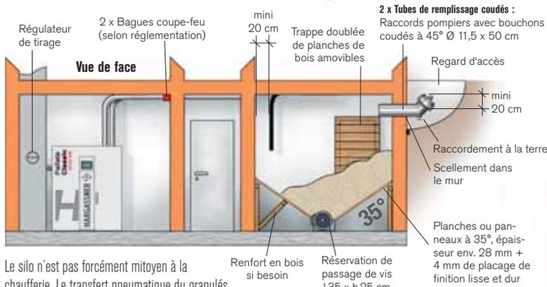
Le silo n'est pas forcément mitoyen à la chaufferie. Le transfert pneumatique du granulés peut se faire jusqu'à 20 m (voire 30 m) de tuyauteries souples.
